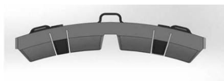
Рис. 1. Колодка композиційна з чавунними вставками
