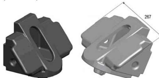
Рис. 2. Фрикційний клин просторової дії Ride Master
