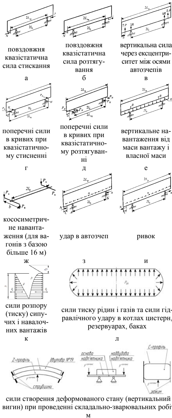
Рис. 3. Розширена схема прикладення навантажень до вагонних конструкцій у різних розрахункових випадках життєвого циклу
