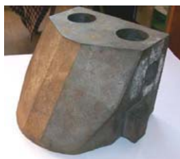
Рис. 7. Клин просторової конфігурації візка 18-1711
