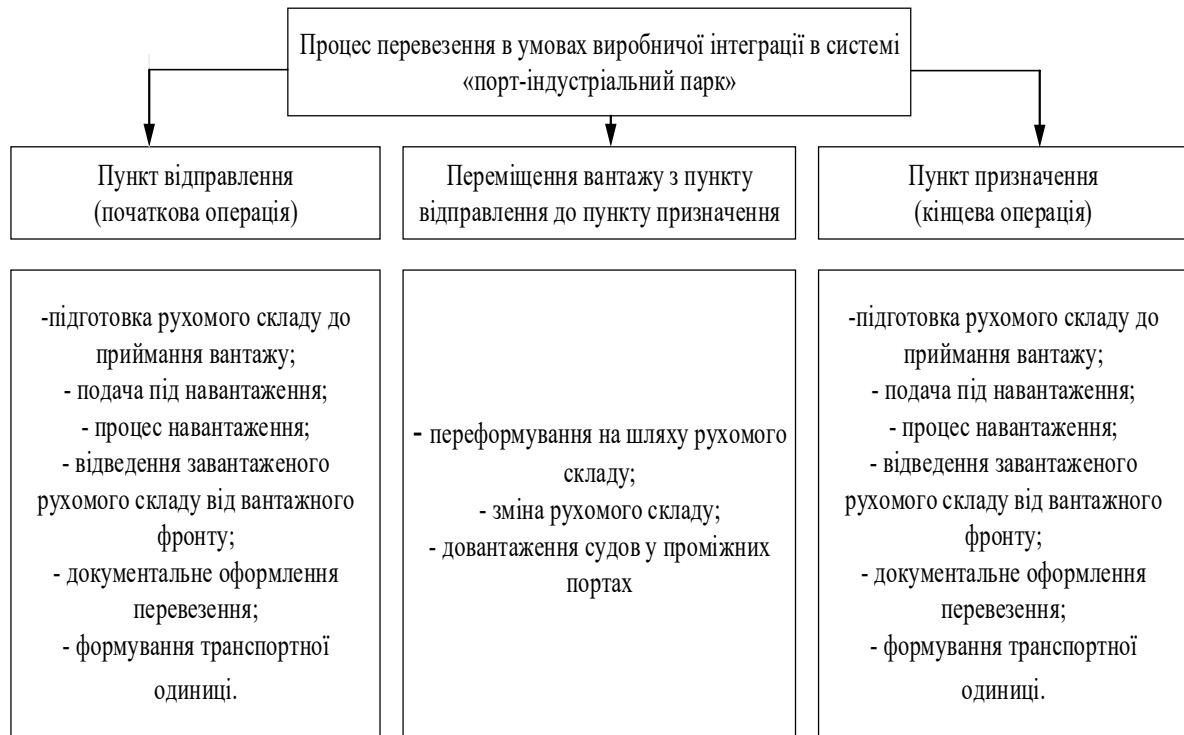
Рис.2. Складові процесу транспортних перевезень в умовах виробничої інтеграції в системі «порт-індустріальний парк»
