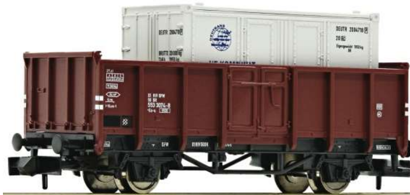
Рис. 1. Розміщення контейнерів у напіввагоні
