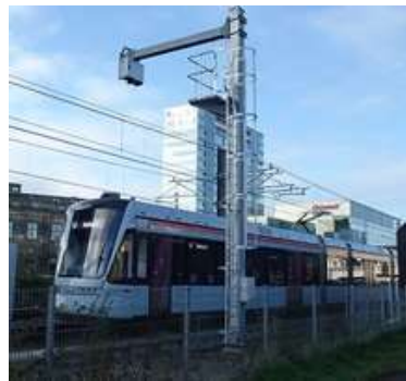
Рис.1. PantoScanner на новій установці на стовпі біля центрального вокзалу Орхуса
