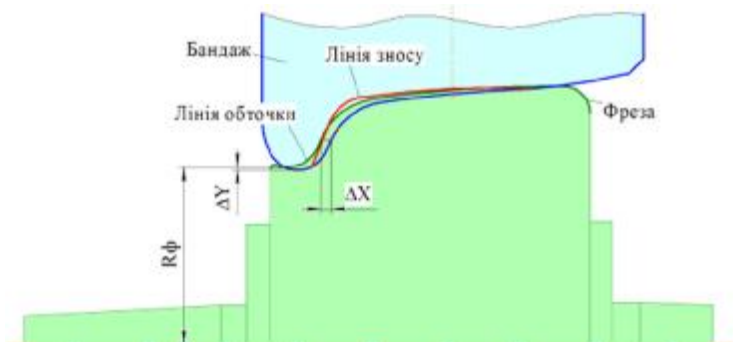
Рис. Схема неповної обточки зношеного профілю «МІНТЕК»
