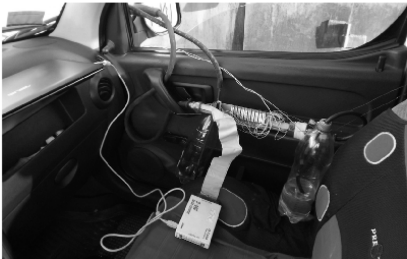
Рис. 1. Налаштування трубки прямої магістралі апаратної частини термоанемометричного витратоміра
