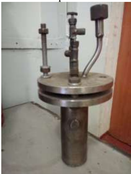
Рис.1 Фото експериментального реактору Реактор для здійснення процесу отримання етилену шляхом каталітичної гідратації етанолу теоретично складається з вертикального корпусу з патрубками підводу вихідної сировини та відводу продуктів реакції, патрубками підводу паливно-воздушної сировини та відводу димових газів.
