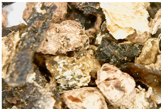
Рисунок 2 - Фото висушеного осаду, що утворився після бродіння побутових відходів
