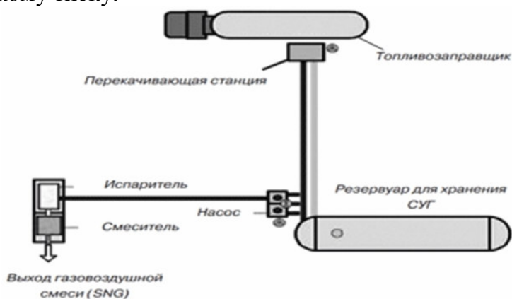
Рисунок 1. Спрощена схема системи виробництва SNG низького тиску.
