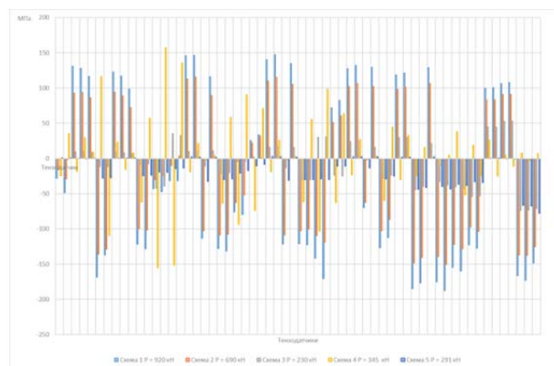
Рис. 3. Осереднені напруження від випробувальних навантажень в елементах конструкції надресорних балок по симетричним точкам однієї деталі
