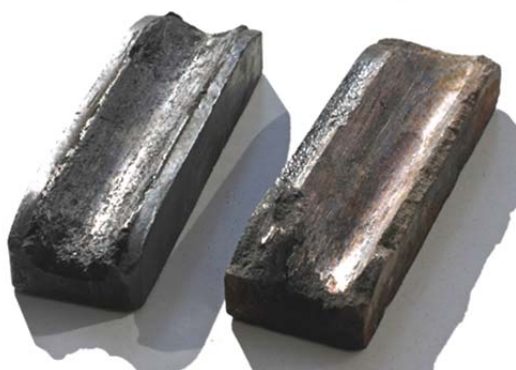
Рис. 1. Вугільні контактні вставки
