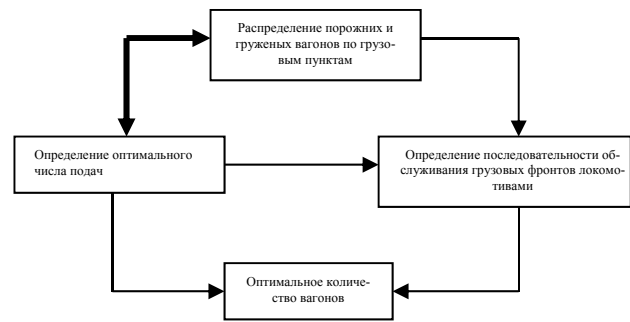
Рис. 2. Структурная схема модели функционирования железнодорожного транспорта предприятия
