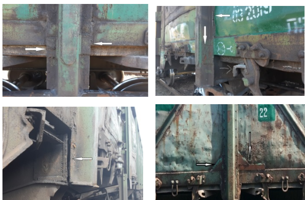
Рис. 1. Характерні пошкодження у вузлах з'єднання елементів рами і стійок бокових стін
