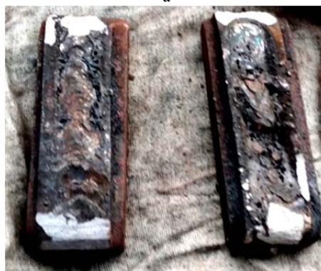
Рис. 4. Металеві контактні вставки: а – нові; б – після наплавлення електродом
