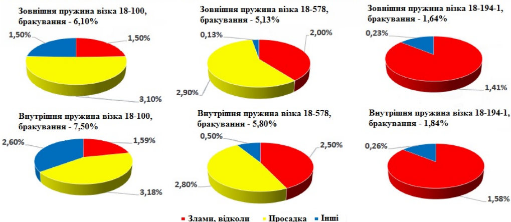
Рис. 2. Причини бракування пружин ресорного комплексу при планових ремонтах вантажних вагонів
