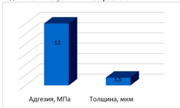
Рис. Величины адгезии и толщины модифицированного слоя образцов СЧ24-44 после имплантации нитрида титана
