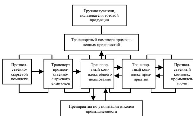
Рис.1. Общая структурная схема работы транспортных комплексов предприятий различных отраслей промышленности
