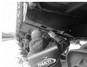
Рисунок 3 – Вимірювання товщини основного металу вагона за допомогою ультразвукового методу НК
