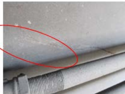
Рисунок 2 – Дефекти у вигляді тріщини хребтової балки виявленого за допомогою візуально-оптичного методу НК
