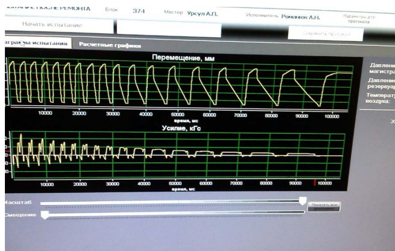
Рисунок 5. Фотофрагмент с экрана монитора ПК с негармоническим законом нагружения гидродемпфера во время испытаний на стенде ИГК-90.1
