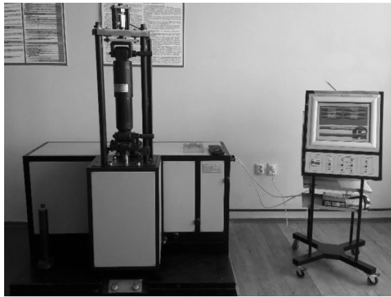
Рисунок 2. Вторая модель стенда ИГК-90.1 (2016 г.в.), который установлен в мотор-вагонном депо Здолбунов (Львовская железная дорога)
