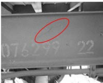
Рисунок 2 – Дефекти у вигляді тріщини хребтової балки виявленого за допомогою візуально-оптичного методу НК
