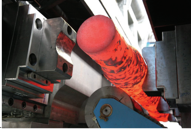
ФОТО 2: Правка оси на гидравлическом правильном прессе RL 400
