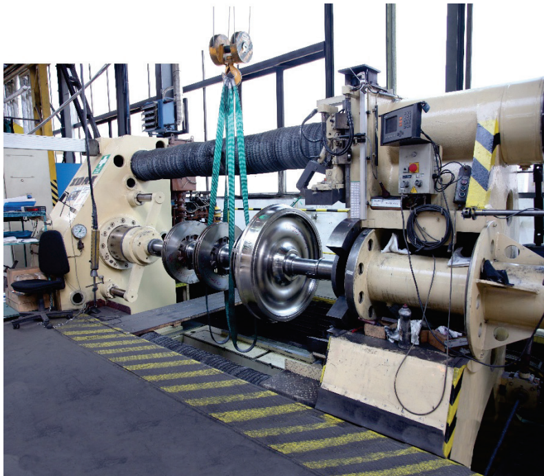
ФОТО 3: Гидравлический пресс CDRA 500 для монтажа и демонтажа железнодорожных колесных пар
