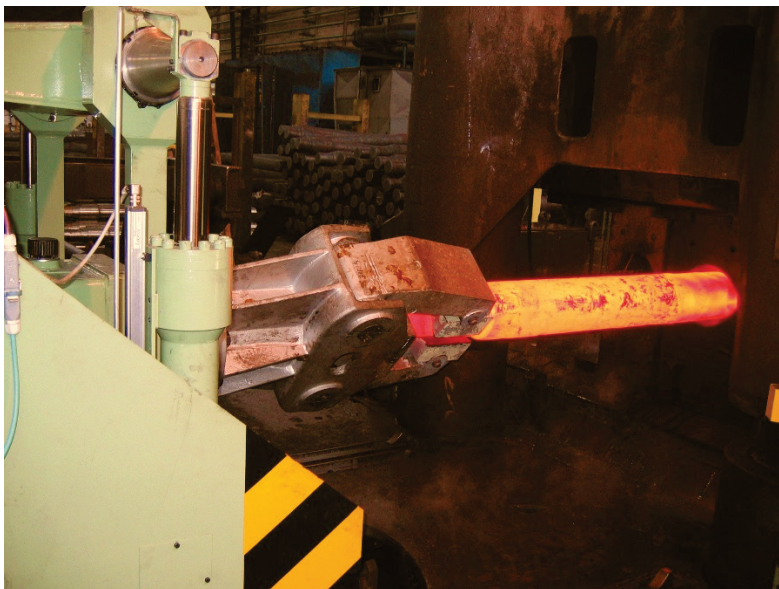
ФОТО 1: Ковка оси в полуштампе на прессе SKNV 1000
