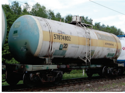
Рисунок 1 – Цистерна моделі 15-1408 для аміака
